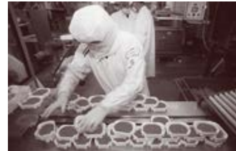
Vorgebeugte Haltung des Oberkörpers → Arbeitshöhe anpassen
