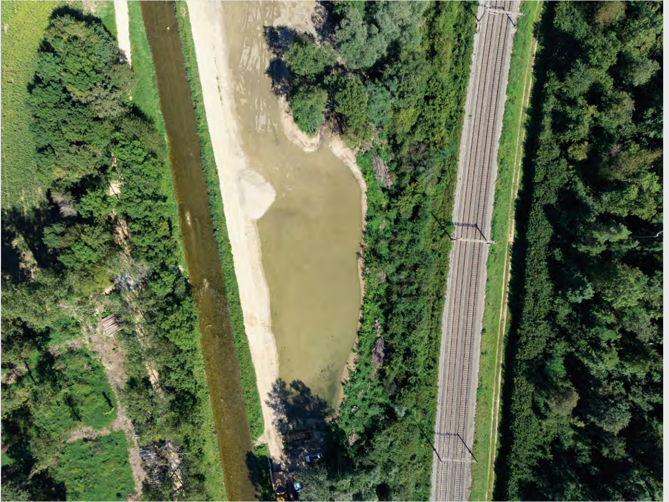
Abschnitt der Venoge (Kanton Waadt) am 4. September 2019. Zwischen Lussery-Villars und Penthelaz wird die Venoge renaturiert. Das neue Flussbett zwischen der Eisenbahnlinie und dem alten Kanal gibt dem Wasser mehr Platz. Davon profitieren sowohl die Biodiversität als auch der Hochwasserschutz.
