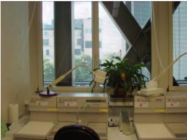
Illustration 15: Poste de travail derrière des éléments statiques et une façade en tôle étirée installée de manière fixe, « effet prison »
