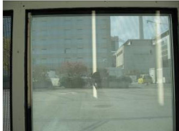
Illustration 9: Les points blancs font l'effet d'un filtre blanc. Le contraste est mauvais (effet laiteux). Ce n'est pas acceptable.
