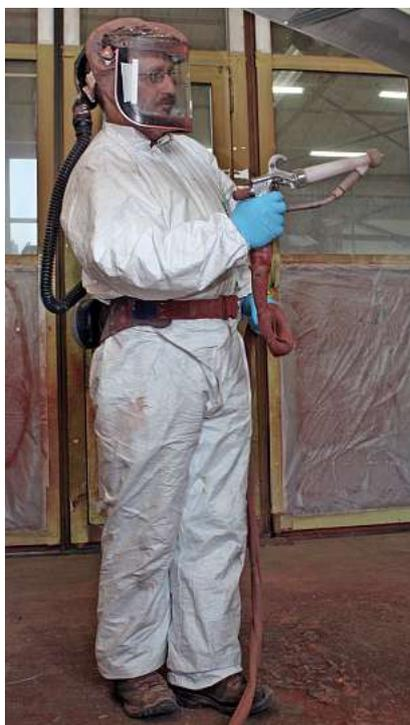
Figura 3: dispositivi di protezione individuale per l'applicazione a spruzzo di prodotti pericolosi (fonte: Suva).
