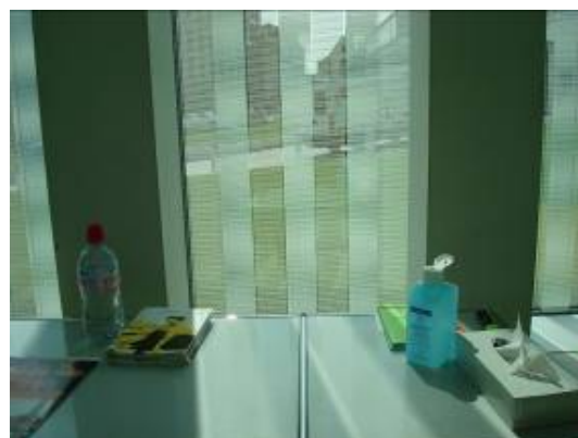
Fig. 6: Modello a strisce, grandi differenze di luminosità, nessuna protezione contro l'abbagliamento, postazione di lavoro non confortevole
