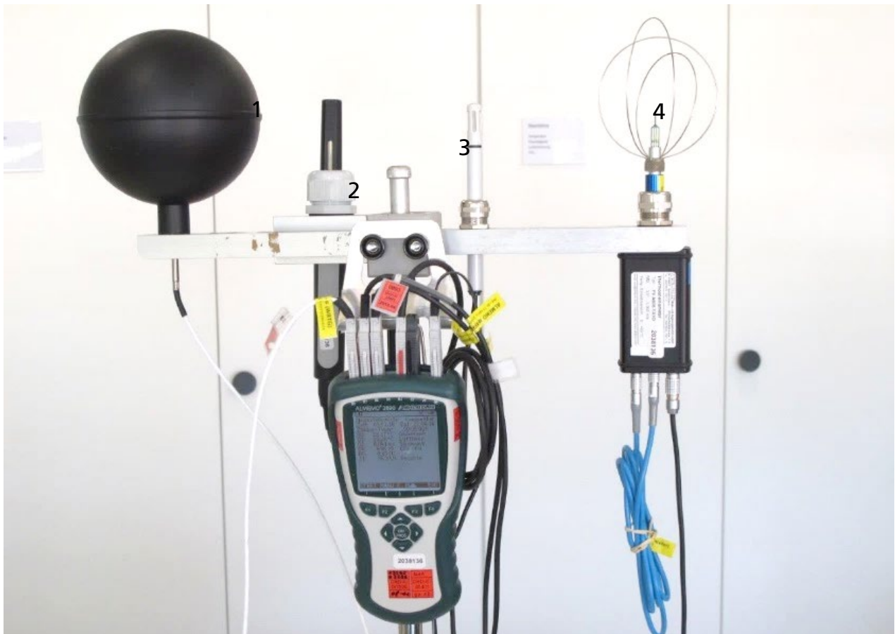
Abb. 316-12: Messeinheit für die Messung des Raumklimas: Messsensoren von links nach rechts: Globe- Thermometer (schwarze Kugel) (1), Sensor für CO 2 (2), Sensoren für rel. Feuchte, Lufttemperatur und Luftdruck (3), Sensor für Luftgeschwindigkeit (4).
