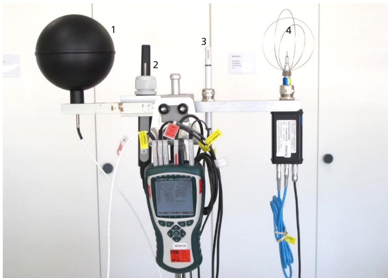
Illustration 316-12: Dispositif de mesure du climat des locaux : capteurs de mesure de gauche à droite : thermomètre globe (« globe noir ») (1), capteur de CO2 (2), capteurs d'humidité relative, température d'air et pression atmosphérique (3), capteur de vitesse d'air (anémomètre)(4).
