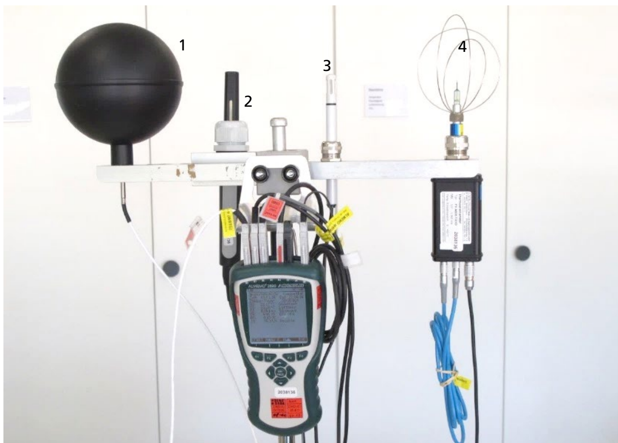
Figura 316-12: Unità di misura per la misurazione del clima dei locali; sensori di misurazione da sinistra a destra: termometro a bulbo (palla nera) (1), sensore per CO 2 (2), sensori per umidità relativa, temperatura dell'aria e pressione atmosferica (3), sensore per velocità dell'aria (4).
